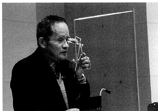
「片手用爪切り」……細長い板の上に、シャモジ状の板が取り付けられ、その下に小さな爪切りが埋め込まれている。梃子の原理を応用し、握力の弱った人が、指の位置を変えなくても片手で爪を切れる道具である。ご丁寧なことに、爪を切る指を拡大して見られるよう、ルーペまでついている。
