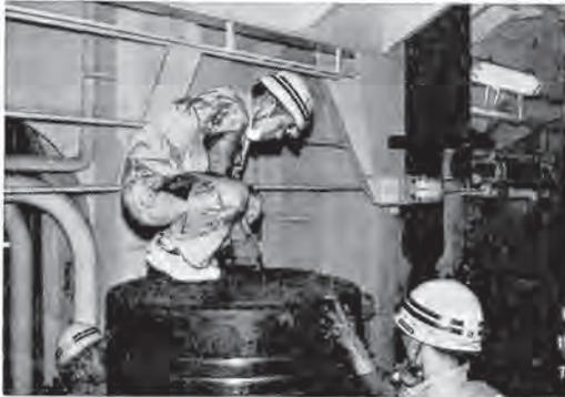
抜き出したピストンのスケール落としをする最若年の操機員
